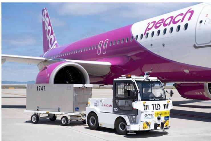
本実証実験は、自動運転技術を活用したランプエリア内における車両走行の実用性を検証するもので、関西空港では初めての取り組みです。ナガセテクノサービスが提供する Tracteam 社製「EZTow」を使用して行われています。2024 年 12 月から 2025 年 4 月 20 日まで「自動運転レベル 3」の実証実験を行い、現在は「自動運転レベル 4」の実証実験を行っています<sup>\*2</sup>。
